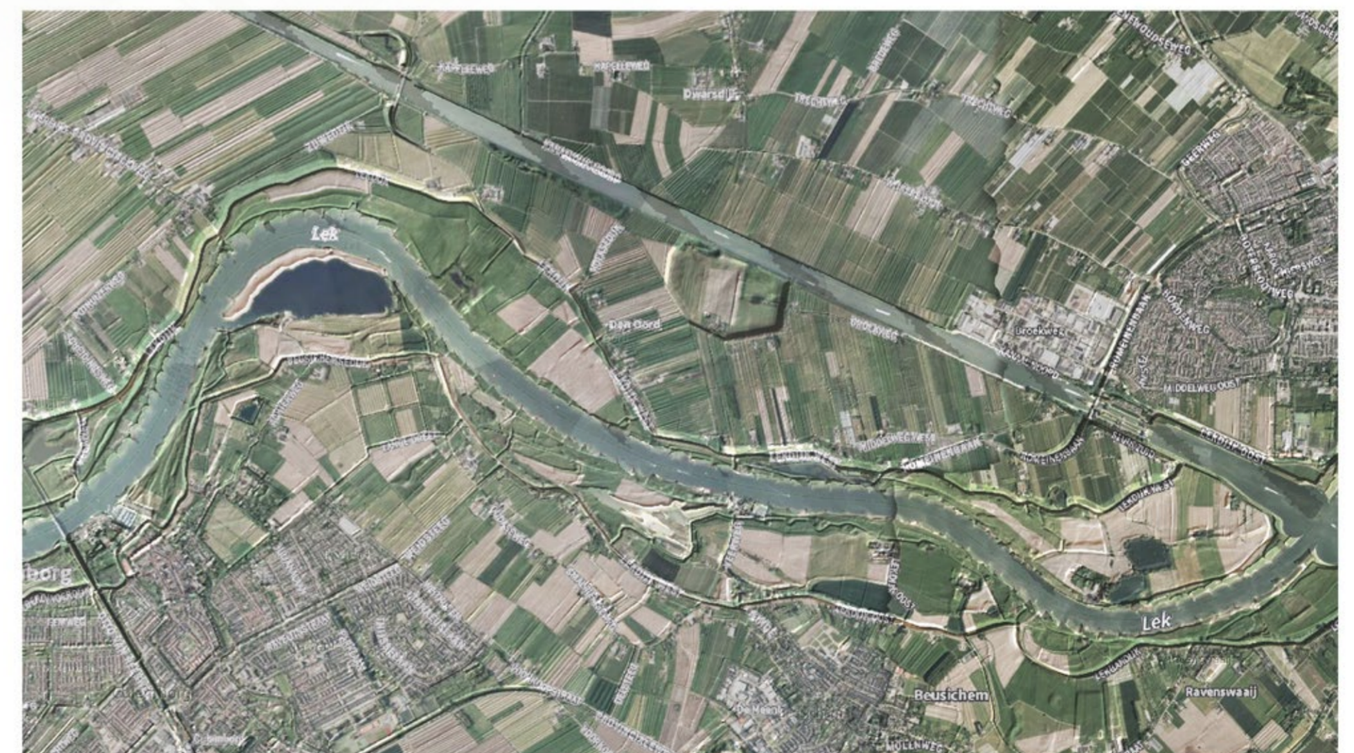
AHN hillshade hoogtekaart geprojecteerd over een satellietfoto van Google Earth. Hier is goed zichtbaar dat de dijk een hoog gelegen lijn is in het landschap en daardoor een belangrijke verbinder is tussen het binnendijkse en het buitendijkse gebied.
